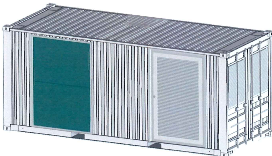
Abbildung 4: Wechselrichtercontainer Layout außen
