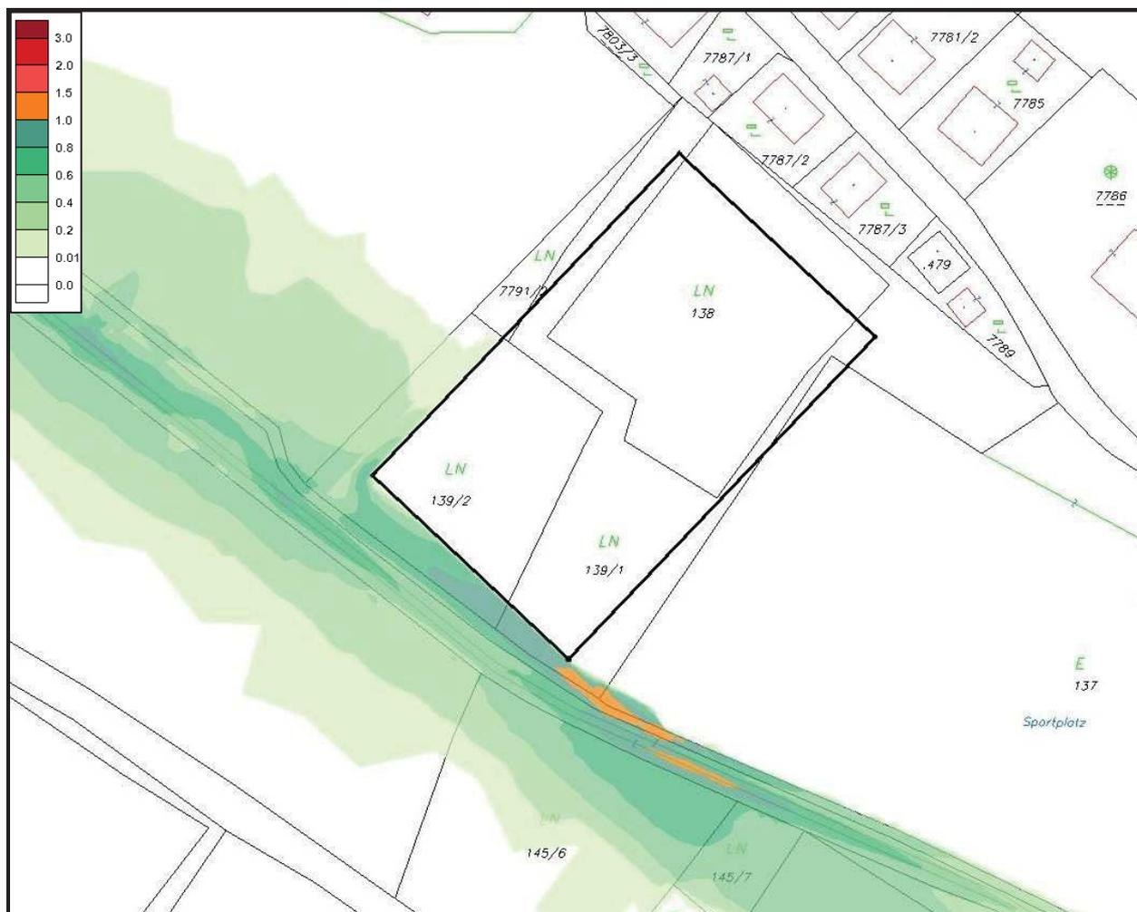
Abbildung 6: Fließgeschwindigkeit bei  $HQ_{30}$  NEU-Zustand
