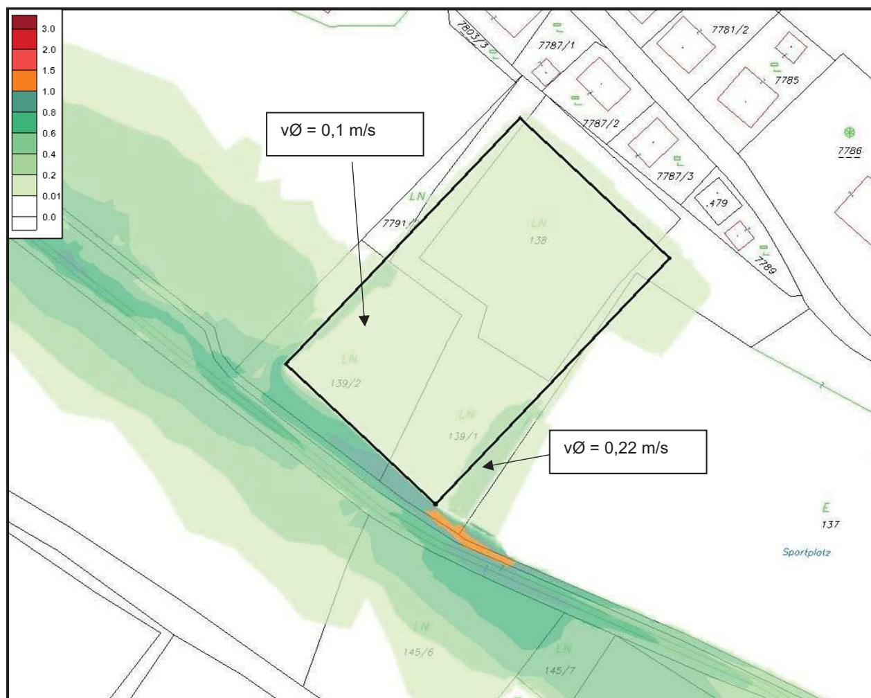
Abbildung 7: Fließgeschwindigkeit bei HQ<sub>100</sub> NEU-Zustand
