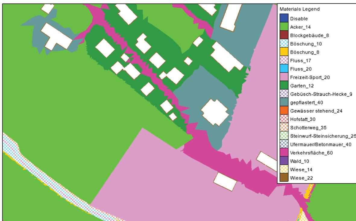
Abbildung 3: Materialbelegung des Geländemodells im Projektbereich
