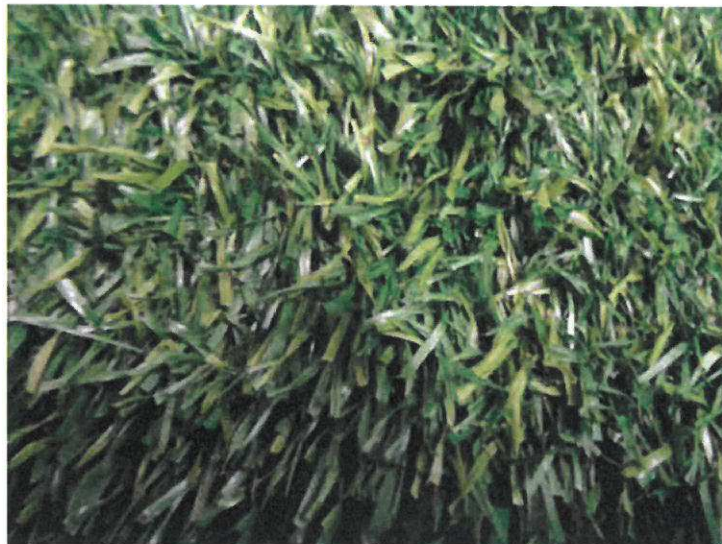
Bild 2: Nach Verschleiß (20.200 Zyklen)
