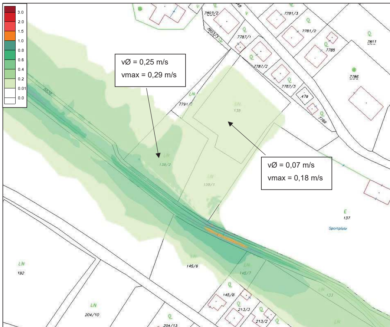
Abbildung 5: Fließgeschwindigkeit bei HQ 30 NEU-Zustand
