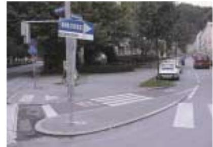
Abb. Radschleuse – Radfahren gegen die Einbahn
